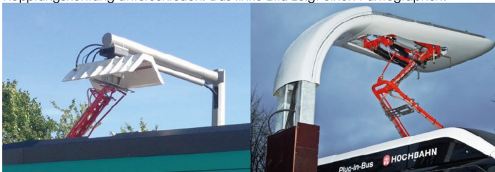
Abbildung 4: Dockings-Stationen - Stromabnehmer am Fahrzeug (links) und Stromabnehmer an der Ladestation (rechts)
